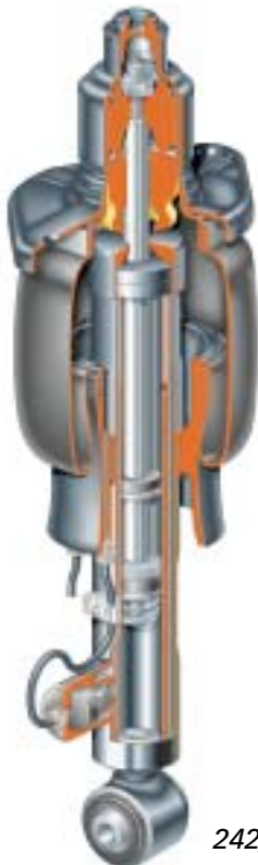
quattro-Antrieb Koaxiale Anordnung für Luftfeder/PDC-Dämpfer
